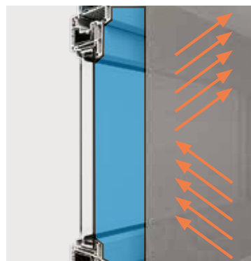
Une protection solaire posée devant la fenêtre est la plus efficace.
