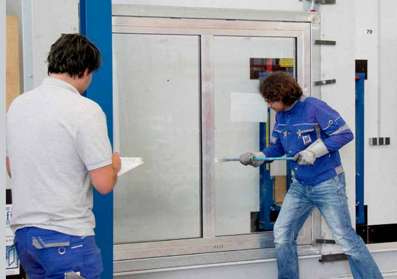
L'ift (Institut für Fenstertechnik) teste la résistance à l'effraction des fenêtres.
