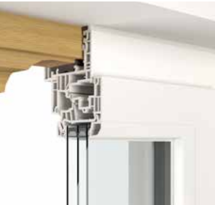
Remplacement des fenêtres avec dépose partielle puis pose en rénovation avec recouvrement total de l’ancien dormant en bois
